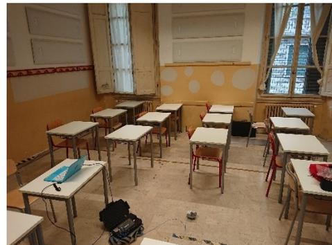
Figura 2 – Misure di vibrazioni indoor.
